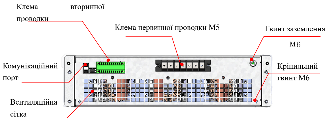
Малюнок 1-20 Задня частина модуля стійки на 30 кВАр/35 А
